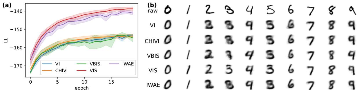
图 3: (a): 测试集上的边缘对数似然关于训练轮数的曲线. (b): 一个原始图像和不同方法重构的图像.
